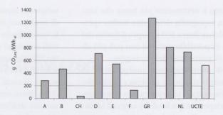
Emissione specifica di CO<sub>2</sub> in g CO<sub>2,eq</sub> /kWh<sub>el</sub>
