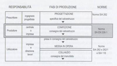
Fig 1 – Fasi del processo di produzione del calcestruzzo e norme implicate
