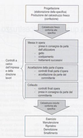
Fig 2 – Posizione, nel ciclo di vita del calcestruzzo, delle fasi di controllo contemplate dal nuovo PCQ
