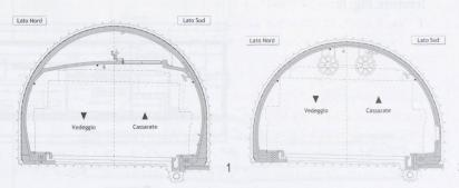
Fig. 1 – Sezione tipo della galleria. Tratta con soletta intermedia.
