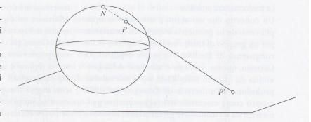
Fig. 6 – La proiezione stereografica: ogni punto P della sfera ad eccezione del polo nord N ha un'immagine P' proiettata sul piano orizzontale lungo la rette passante per N.
