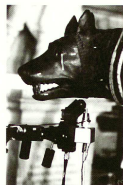
Fig 1 - Schema di un apparato sperimentale portatile per l'analisi di campioni tramite fluorescenza X. Il sistema comprende un generatore dei raggi X, i quali, dopo collimazione, investono una piccola zona del campione; le radiazioni X caratteristiche sono rivelate da un dispositivo al silicio dedicato (e raffreddato tramite una cella Peltier) i cui segnali vengono amplificati e poi analizzati. Ad ogni picco sullo schermo corrisponde un particolare elemento nel campione. Tratto da «A new portable XRF spectrometer based on Silicon Drift Detector for non-destructive analyses on the cultural heritage», Carlo Fiorini, Alessandra Gianoncelli e Antonio Longoni, Politecnico di Milano.
