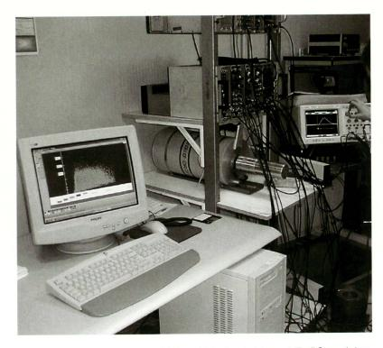
Fig 3 – Un moderno laboratorio per analisi X e g, dotato di un rivelatore portatile di Germanio iperpuro collegato ad un contenitore di azoto liquido trasportabile: l'autonomia di funzionamento è di qualche giorno. Il laboratorio è dotato di moduli elettronici per l'analisi in energia e tempo dei segnali, mentre con un oscilloscopio se ne controlla l'andamento temporale. Sul monitor in primo piano i risultati di una elaborazione dei segnali.
