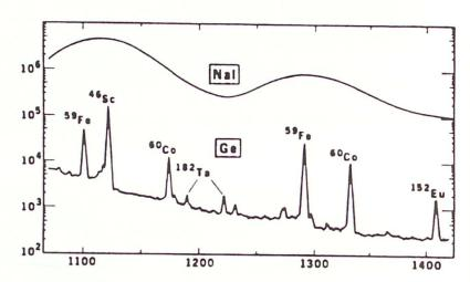
Fig 4 – Spettri di radiazioni  $\gamma$  nell'intervallo da circa 1100 - 1400 keV raccolti con un rivelatore dia scintillazione di Nal (TI) e di germanio iperpuro, quest'ultimo con una risoluzione circa 40 volte migliore.
