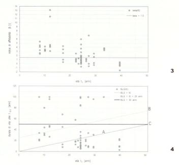
Fig. 3 – Indice di affidabilità  $\beta$  delle facciate in calcestruzzo esaminate in funzione della loro età  $t_{\rm n}$ .
