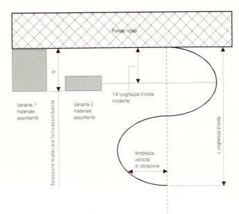
Fig. 1 - Schema d'assorbimento di un'onda sonora
