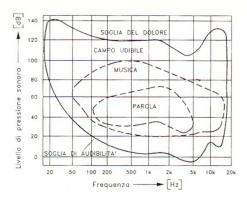
Fig. 5 – II livello sonoro in funzione della frequenza
