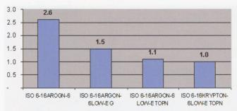
Grafico 1: Trasmittanza Termica U in W/m2K
