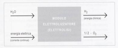
4 – La rappresentazione schematica di un elettrolizzatore
