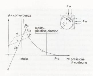
9 - Linee caratteristiche di cavità e sostegni
