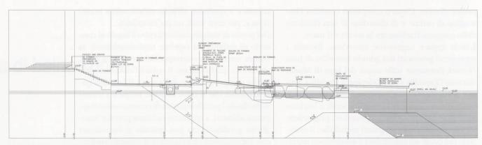
Sezione della zona più a sud. In sequenza da sinistra: scalinata in cemento, piano orizzontale rivestito in pietra, piano inclinato rivestito in legno, mare profondo 80 cm, sbarramento in cemento, mare.
