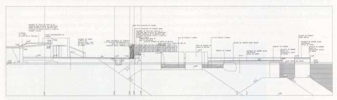
Sezione della zona centrale. In sequenza da sinistra: zona con cabine, piano orizzontale rivestito in pietra (17 m), canneto, muri in cemento armato alti 2 metri e 70 a delimitare la zona detta «del mare sicuro», isola in marmo bianco, mare.
