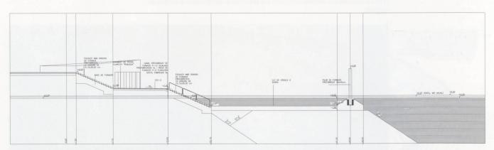
Sezione della zona più a nord. In sequenza da sinistra: scalinate, piano orizzontale rivestito in pietra (8.5 m), scalinata che scende in mare (profondo 1.2 e largo 20 m), linea di pali in cemento prefabbricato, mare.
