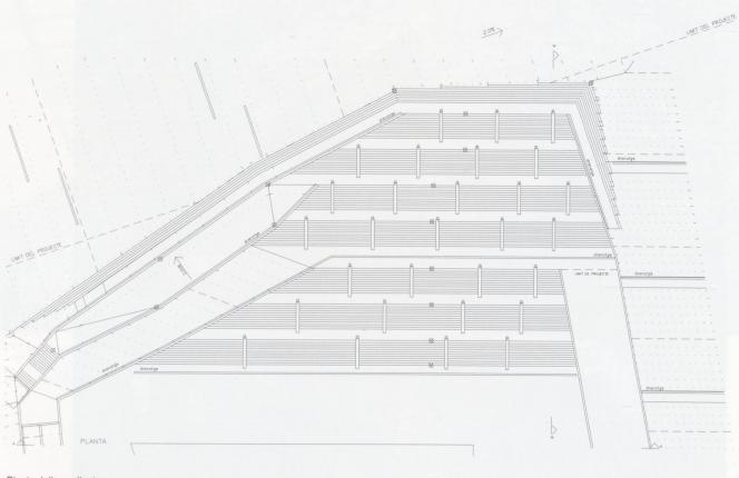
Pianta delle scalinate. Da notare la disposizione sfalsata degli elementi corrimano che, di notte, provvedono all'illuminazione delle scalinate.
