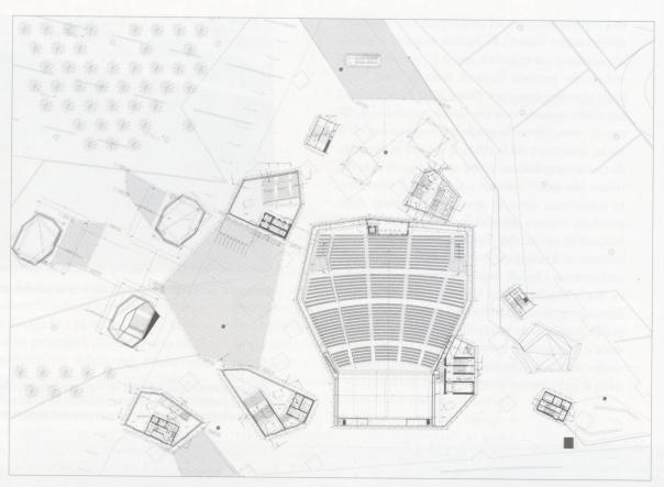
Pianta livello piazza; da notare i corpi cavi che incanalano la luce e la conducono, attraverso l'edificio, fino alla quota interrata.
