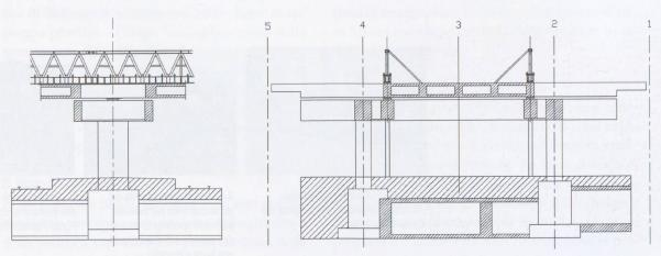
7 – Sezione longitudinale e trasversale del ponte e sottostruttura nello stadio di costruzione
