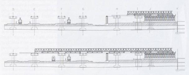
6 – Fasi di spostamento sopra i binari con il metodo dell'estrusione cadenzata senza interruzione del traffico ferroviario. Inizio getto dei singoli elementi di ponte verso la testata Sud. La durata di preparazione di un singolo elemento è di circa 3 settimane compreso lo spostamento
