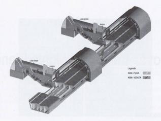
3 – Luoghi sicuri con possibilità di evacuazione attraverso i canali per l'aria fresca situati al disotto del campo stradale
