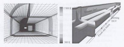
8 – Simulazione tridimensionale dell'incendio di un veicolo pesante nella galleria stradale del San Gottardo. Il dominio di calcolo comprende il vano traffico ed il canale di estrazione, con tre serrande aperte. A sinistra: griglia di calcolo. A destra: distribuzione di temperatura
