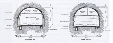
1 – Sezioni tipo della galleria semiautostradale del San Gottardo. La differenza tra il profilo nord (a sinistra) ed il profilo sud (a destra) è risultata da un'ottimizzazione tecnico-economica del progetto, in funzione in particolare della posizione dei pozzi di ventilazione
