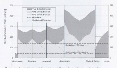
10 – Aspirazione in funzione della posizione dell'incendio, con tre serrande aperte. Le quantità aspirate sono già state corrette in funzione delle perdite di aria dal sistema
