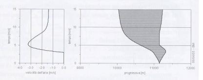
6 – Propagazione fumi, sistema originario con aspirazione ripartita. Il diagramma di sinistra mostra la velocità longitudinale in corrispondenza dell'incendio, mentre quello di destra illustra l'evoluzione temporale della propagazione dei fumi
