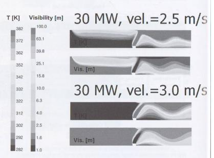
17 – Campi di temperatura e visibilità (sezioni longitudinali) in caso di incendio di un veicolo pesante. Simulazione tridimensionale realizzata utilizzando il programma FLUENT
