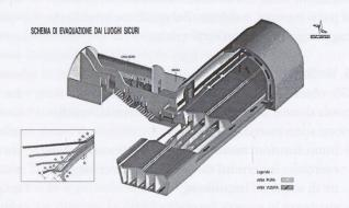
11 – Sistema di ventilazione semitrasversale (traforo del Monte Bianco). Quattro canali sotto la carreggiata garantiscono l'apporto di aria fresca, mentre il quinto viene utilizzato per l'estrazione dei fumi in caso di incendio
