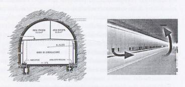
12 – Sistema trasversale di ventilazione (galleria stradale del San Gottardo). L'aria fresca viene iniettata attraverso le aperture laterali, mentre l'estrazione avviene in volta
