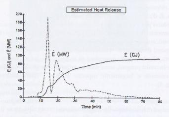
5 – Potenza e sviluppo complessivo di calore per un veicolo pesante con carico modesto, 2 t di mobili (EUREKA 499, test HF1)
