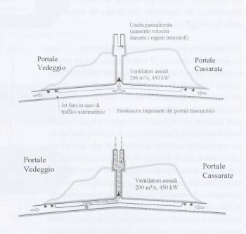
9 – Ventilazione della galleria Vedeggio-Cassarate, in via di realizzazione. In condizioni normali di funzionamento la ventilazione è di tipo longitudinale, con estrazione al centro. In caso di incendio un sistema di serrande nella soletta intermedia permette di concentrare l'aspirazione dei fumi in prossimità dell'incendio. In entrambi i casi l'espulsione avviene attraverso un camino
