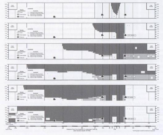
7 – Memorial Tunnel (lunghezza 854 m), test 501, 20 мw. Propagazione fumi 0, 1, 2, 3, 4 e 5 min. dopo l'accensione
