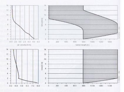
15 – Propagazione fumi nel tubo discendente della galleria del Markusbierg, Lussemburgo (lunghezza 1'575 m, pendenza 5%, ventilazione longitudinale). Sopra: senza ventilazione; sotto: 12 *jet fans* in funzione. Le figure a sinistra mostrano l'evoluzione temporale della velocità dell'aria in galleria, quelle a destra la propagazione dei fumi nel tempo
