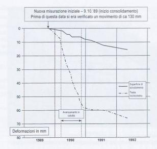
16 – Registrazione dei movimenti nel tempo lungo due quote determinanti (superficie di taglio risp. testa dell'inclinometro)
