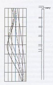
10 – Deformazioni delle paratie per differenti fasi di scavo
