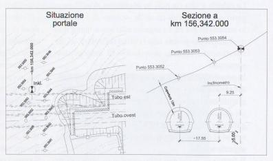
Punti di misurazione in superficie e posizione inclinometro
