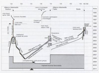
4 – Programma di lavoro secondo il progetto di appalto. È previsto l'uso di una fresa a doppio scudo e l'opzione di un cunicolo di trasporto a partire da Faido, come misure a garanzia del programma di esecuzione
