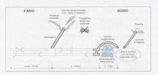
2b – Attraversamento separato e indipendente della frana di Bodio, lungo 420 m, con le due canne principali
