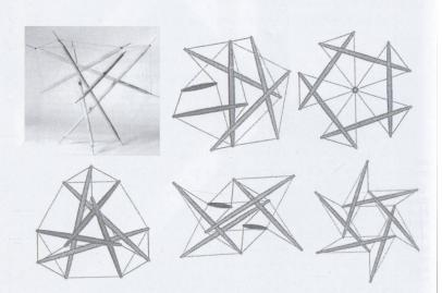
3 – Alcuni esempi di cellule base del sistema Tensegrity Fonte: R. Motro, A. Smaili and O. Foucher, Form controlled for tensegrity formfinding Snelson and Emmerich examples <sup>3</sup>
