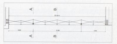
8 - Pianta sistema di irrigidimento
