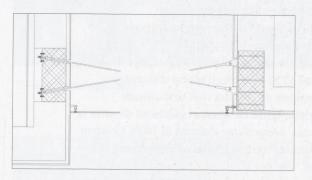
9 - Dettagli ancoraggi cavi nella struttura esistente
