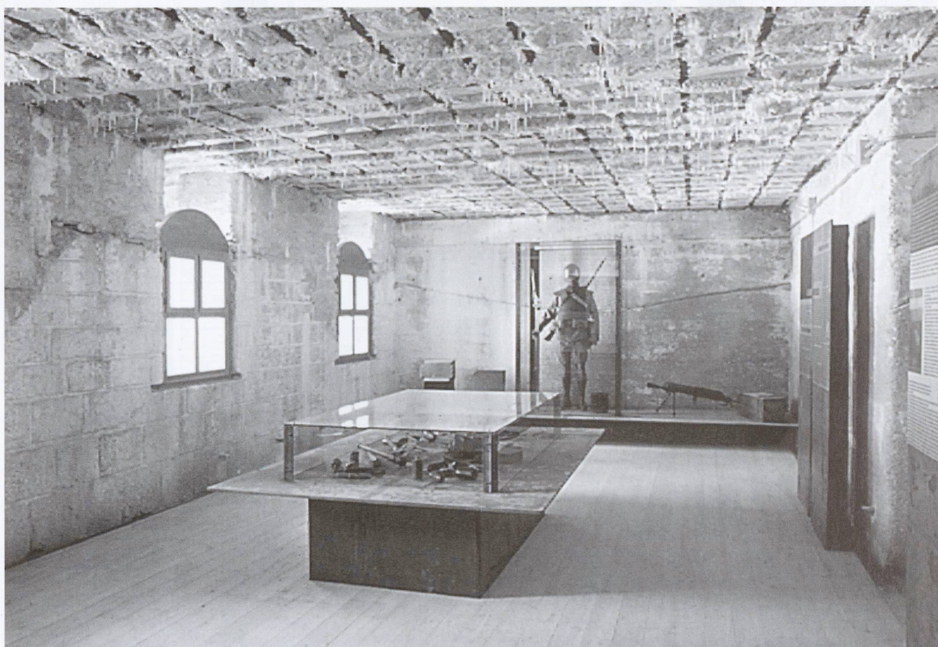
Sala con l'ardito (lamiere acidate e saldate di forte spessore, lastre in cristallo temperato imbullonate a profili metallici acidati e a spigolo vivo, serramenti in larice all'anilina grigioverde)
