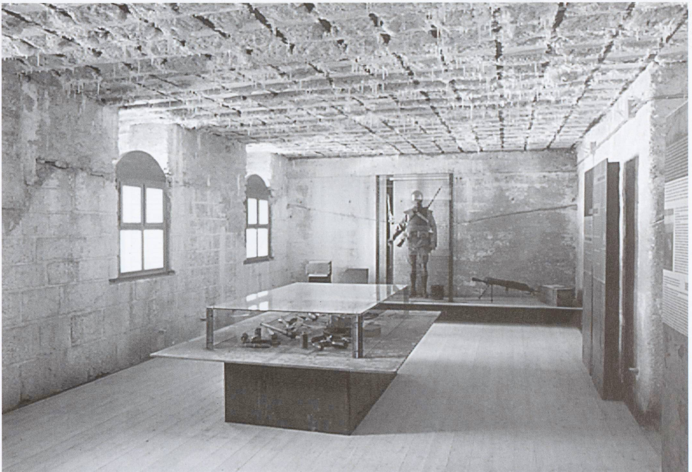
Sala con l'ardito (lamiere acidate e saldate di forte spessore, lastre in cristallo temperato imbullonate a profili metallici acidati e a spigolo vivo, serramenti in larice all'anilina grigioverde)
