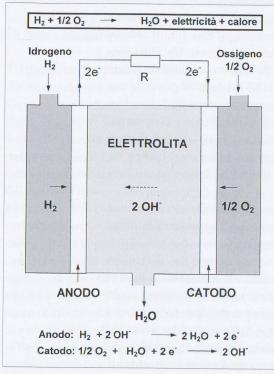
Schema di funzionamento di una cella combustibile
