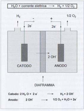
Schema di funzionamento di un elettrolizzatore
