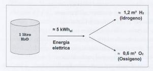
L'elettrolisi di un litro d'acqua (1,2m³ di H₂ ≈ 4kWh di energia chimica)
