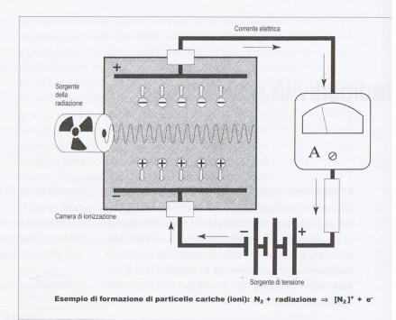
Rappresentazione schematica di una camera di ionizzazione – la radiazione ionizza la materia gassosa e le particelle caricate vengono attirate dall'elettrodo di carica opposta. Il flusso di elettroni (corrente), misurabile, è proporzionale al numero di coppie di ioni prodotte
