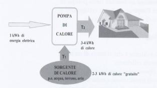
Fig.1 - La pompa di calore
