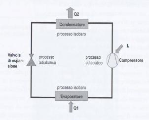
Fig. 2 – Il ciclo termodinamico della pompa di calore
