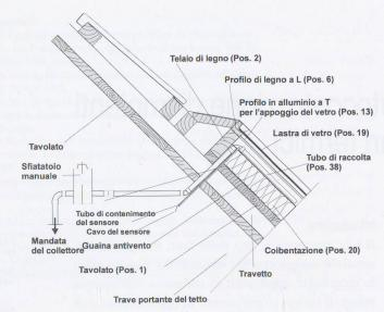
Sezione C-C del collettore solare
