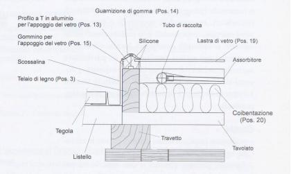
Sezione A-A del collettore solare
