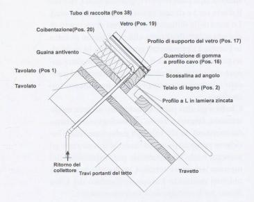
Sezione B-B del collettore solare
