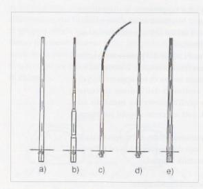
Figura 6 – Pali in acciaio: a) pali conici diritti laminati; b) pali rastremati diritti laminati; c) pali conici curvi laminati (a mensola); d) pali conici diritti da lamiera; e) pali da lamiera, ottagonali, diritti
