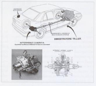
Fig. 3 – Vettura TRUST con differenziale C.Y.M.E.N.T.O.
