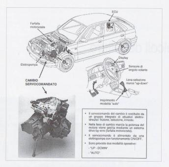
Fig. 1 - Veicolo con cambio robotizzato ERGO
