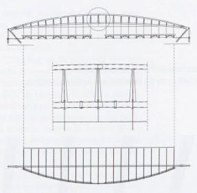
Sezione trasversale e pianta della pensilina
