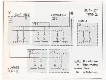
11 — Schema monofase di alimentazione elettrica: i due circuiti d'alimentazione devono sempre essere separati
