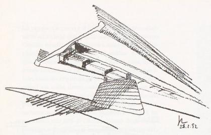
Le pile centrali si sono sviluppate anch'esse su questi principi: una parte appartenente alla terra, massiccia, organica, sulla quale poggia la struttura dinamica del ponte.
