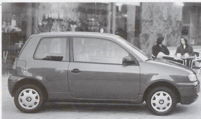
2 — Seat Arosa, motore in alluminio da 1 litro, ABS, airbag lato conducente, consumo 5,7 l/100 km (93/116/CEE)
