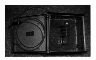
5 — Armadietto di cablaggio per l'organizzazione dei sensori e per centralizzare i punti di misura
