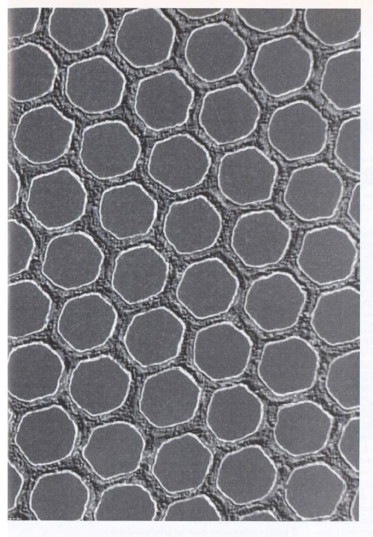
3 — Sezione di un cavo superconduttore a bassa temperatura composta da una lega di niobio e titanio Sullo sfondo è rappresentato un ingrandimento della struttura filamentare del cavo
