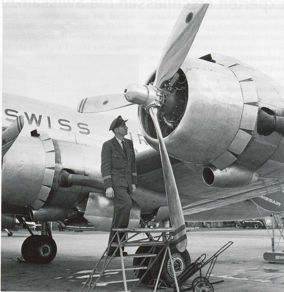
Originalbildinformationen: Pilot vor Propeller, ohne Jahr. Ergänzte Bildinformationen: Flight-Engineer Alfred Wegman (1917-2007) bei der Aussenkontrolle der Douglas DC-4-1009 A, HB-ILA «Genève» vor dem Start in Genf-Cointrin. Alfred Wegmann flog bei Swissair als Bordmechaniker und Flight Engineer von 1947 bis 1973, ca. 1950 (LBS_SR01-05479).
