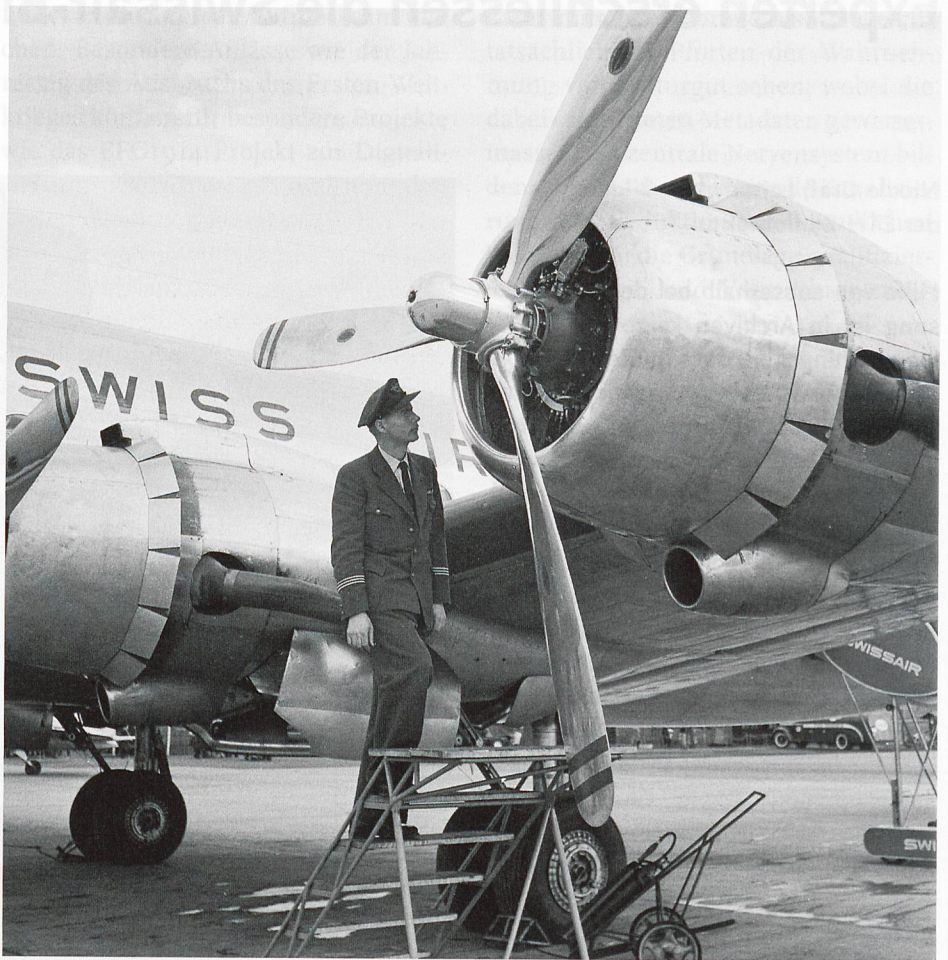
Originalbildinformationen: Pilot vor Propeller, ohne Jahr. Ergänzte Bildinformationen: Flight-Engineer Alfred Wegman (1917-2007) bei der Aussenkontrolle der Douglas DC-4-1009 A, HB-ILA «Genève» vor dem Start in Genf-Cointrin. Alfred Wegmann flog bei Swissair als Bordmechaniker und Flight Engineer von 1947 bis 1973, ca. 1950 (LBS_SR01-05479).
