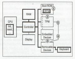
Abb. 2: Architektur des TC (bearbeitet nach der TCG-Specification, Rev 1.28).
