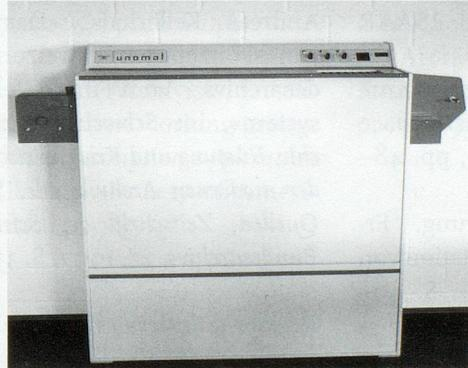
Komfortable Filmentwicklung. Automatisch gesteuerte Funktionen für: Regenerierung, Bädertemperatur, Filmtröcknung. Interne Warmwasseraufbereitung, kein Boiler erforderlich.
