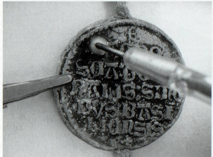
Elektrolytischer Restaurierungsprozess mit Platinanode.
