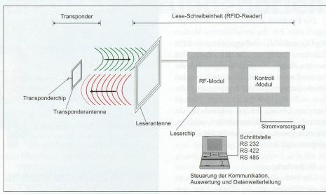
Abb. 1: Funktion und Aufbau eines RFID-Systems.
