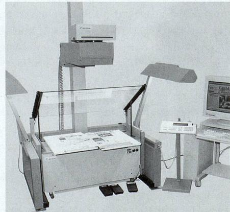
Bedienungsmodi: Nur Scannen, nur Verfilmen oder gleichzeitig Scannen **und** Verfilmen. Die automatische Hybrid-Funktion erfasst in nur sieben Sekunden eine Vorlage archivsicher! Flexible Buchwippen sichern den schonenden Umgang mit dem Original.
