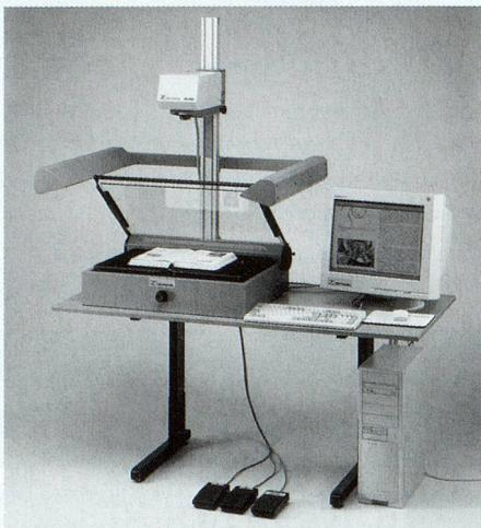
Vorlagen bis A2 werden nach Wahl mit 2, 16 oder 256 Graustufen bei einer Auflösung von 200 bis zu 600 dpi abgelichtet. Die hohe Schärfentiefe von 50 mm bildet die Buchmitte mit und ohne Glasplatte schattenfrei ab.
