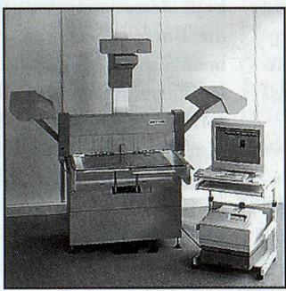
Bücher, Zeitungen, Zeichnungen scannen und verfilmen oder nur scannen oder nur verfilmen. In hervorragender Qualität bis 400 dpi. Entweder "SMA 0 6650" mit "Mikrofilm-Kamera" oder "SMA 1 6650" mit "Mikrofilm-Kamera". Alle Angaben der Einzelgeräte treffen in der jeweiligen Kombination auch auf das Hybridgerät zu. Inklusive "Spezial-Buchwippe" oder den Einzugs-Scanner-Aufsatzen. Ein Gerät für alles - eine neue Idee von SMA. Mehr Information erhalten Sie direkt von: TECNOCOR HANDELSAG
