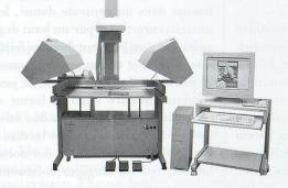
Mit 24 bit voll in die Farbe geht der Grossformatscanner **Omniscan 6000 Color** bei Vorlagen bis DIN A1. In weniger als neun Sekunden ist die Vorlage von der CCD-Zeile mit 5000 Pixel farbgetreu erfasst: Die Auflösung variiert bezogen auf das Original von 600 dpi bei DIN A4 bis 200 dpi bei A1.
