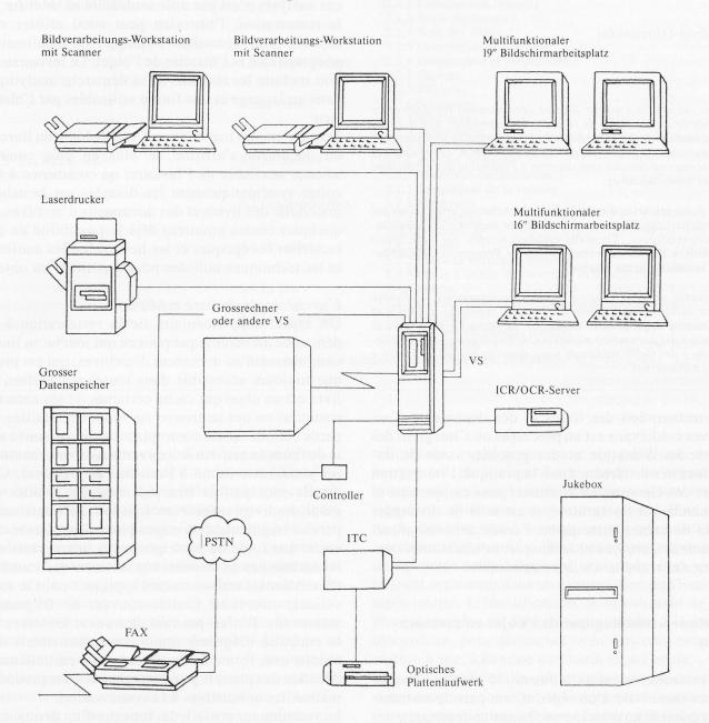
Moderne Archivierungs- und Dokumenten-Verarbeitung wird heute via Bildverarbeitung gelöst. Ein eingescanntes Dokument, welches als elektronisches Bild im System liegt, kann sehr einfach wieder gefunden, verarbeitet oder als Beispiel via Fax versandt werden. Das Ein-
