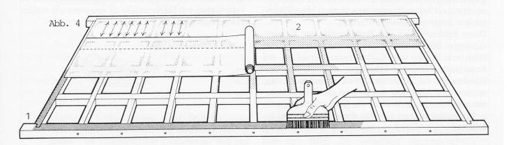
1 verleimte Holzprofile, 2 Japanpapierbahnen, beidseitig in sechs Aufbau eines Karibari: Schichten aufgeklebt
