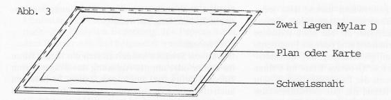
Einschweissen des Objekts zwischen zwei Mylarfolien 50-75my dick, geschweisst wird mit Ultraschall, das Objekt kann jederzeit herausgeschnitten werden, da mit dem Einschweissen keine Klebstoffe verwendet werden. (engl. Fachausdruck: encapsulation)
