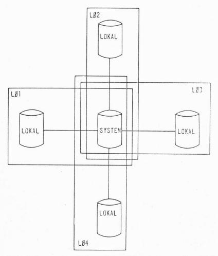
Abb. 2: Der zentrale Systembereich wird von allen Teilnehmern mitbenützt. Er ist solcherart konzipiert, daß jeder die gespeicherten bibliographischen Erfassungen eines anderen mitbenützen kann, er hat dann bloß noch seine eigenen Bestandesinformationen hinzuzufügen. Hingegen bleibt der lokale Bereich der Datenbank der ausschließlichen Benützung jedes einzelnen Teilnehmers vorbehalten.
