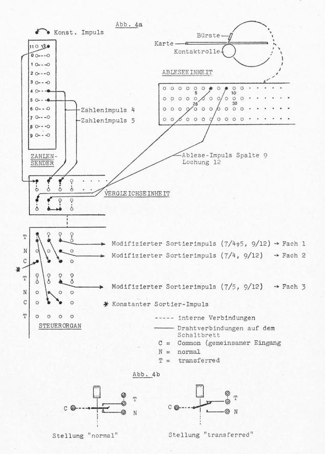
Eine Besonderheit der Maschine soll nicht unerwähnt bleiben; es ist nämlich möglich, mit einer einzigen Schaltung auf der Schaltplatte mehrere Probleme gleichzeitig zu lösen, sofern sich die gestellten Fragen nicht überschneiden. Dies bedeutet nicht nur einen Zeitgewinn, sondern auch eine Schonung der Karten, indem nicht für jedes Problem ein besonderer Kartendurchgang notwendig ist.
