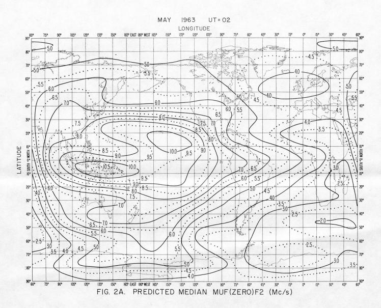
Abb. 6. Vorhersagekurven, sog. Ionospheric predictions, wie sie auf Grund der Messergebnisse von rund 50 Beobachtungsstationen erstellt werden.
