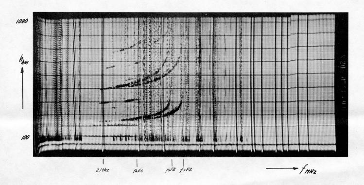
Abb. 5. Mikrofilmaufnahme einer lonospährenmessung
